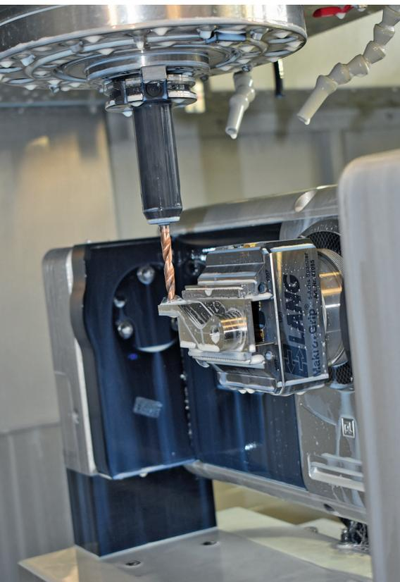
1 Auf der Zusatzachse der Quaser MV 204 V kann K.U.M. Werkstücke bis zu einem Durchmesser von 200 mm und einer Höhe von 160 mm spannen © Hommel
